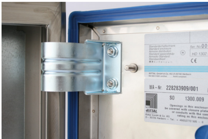
Bild 8. So sieht der HD-Schrank im Bereich des oberen Scharniers vor dem Versuch aus.
