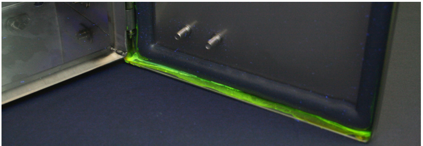
Bild 7. Nach der Reinigung eines normalen Gehäuses sind nicht alle Verschmutzungen beseitigt.
