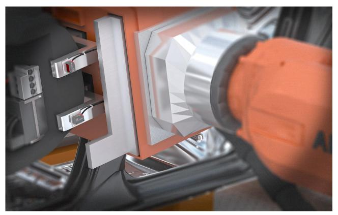
Karosseriepositionierung in der Produktionslinie: Für automatisierte Bearbeitungsvorgänge an Karosserien bzw. Fahrzeugen ist eine exakte Bestimmung der Position relativ zum Bearbeitungswerkzeug notwendig, z.B. zum Bohren, Stanzen und Teileanbau.
