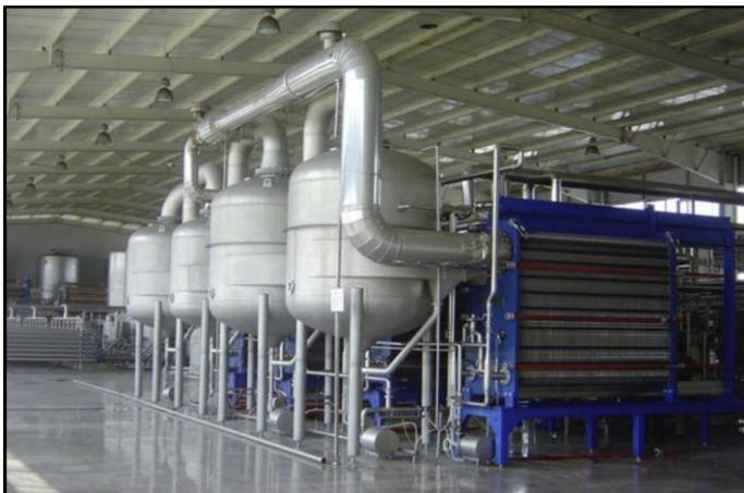
Allen Systemen gemein ist die hohe thermische Effizienz, insbesondere im Vergleich zu herkömmlichen Fallstrom-Verdampfern, so dass die Betriebskosten gering gehalten werden können und die Amortisationszeit einer Neuinvestition sehr kurz ist. Ermöglicht wird dies zum einen durch die geringe Temperaturdifferenz, zum anderen durch das intelligente Anlagendesign.
