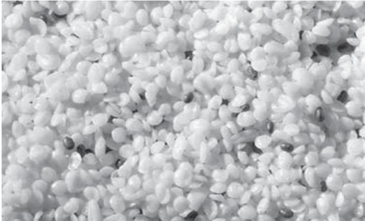
**Abbildung 5.1:** Ein klein wenig Farbzusatz reicht zum Einfärben des Kunststoffes.
