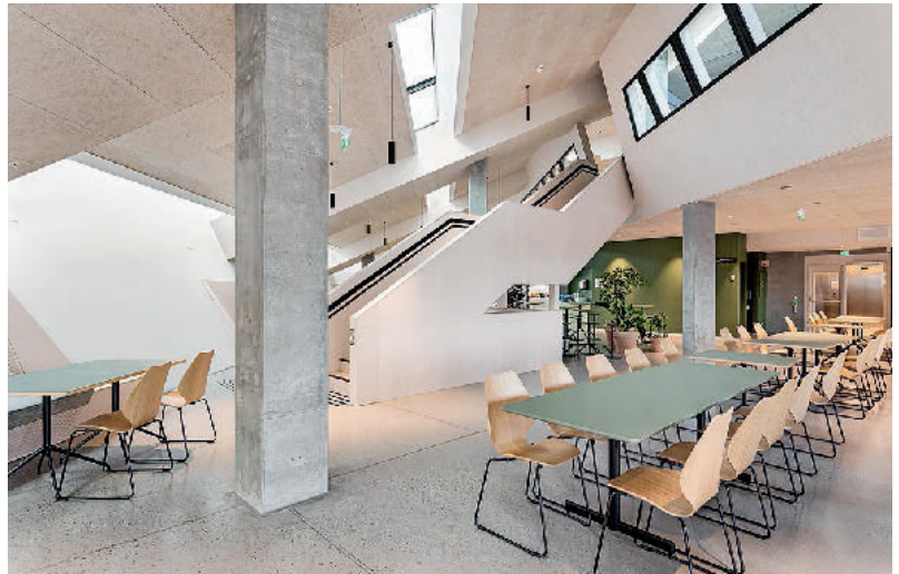
Die Tagungsräume sind offen gestaltet und mit viel Tageslicht durchflutet. Sie werden über Oberlichter belichtet, die mit schaltbarem Sonnenschutzglas ausgestattet sind.
