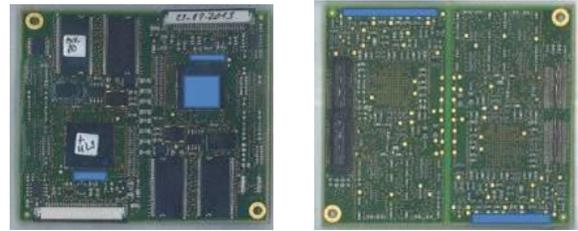
**Abbildung 2.** Ober- und Unterseite der als Versuchsträger verwendeten Leiterplattenbaugruppe.
