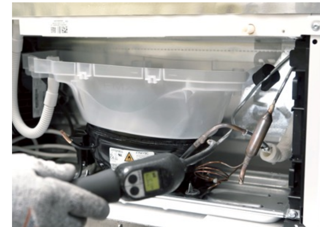
Anwendungen wie die Leckageprüfung werden in der Regel von Menschen durchgeführt, da sie geschickt im Umgang mit auftretenden Varianzen im Prüfvorgang sind.
