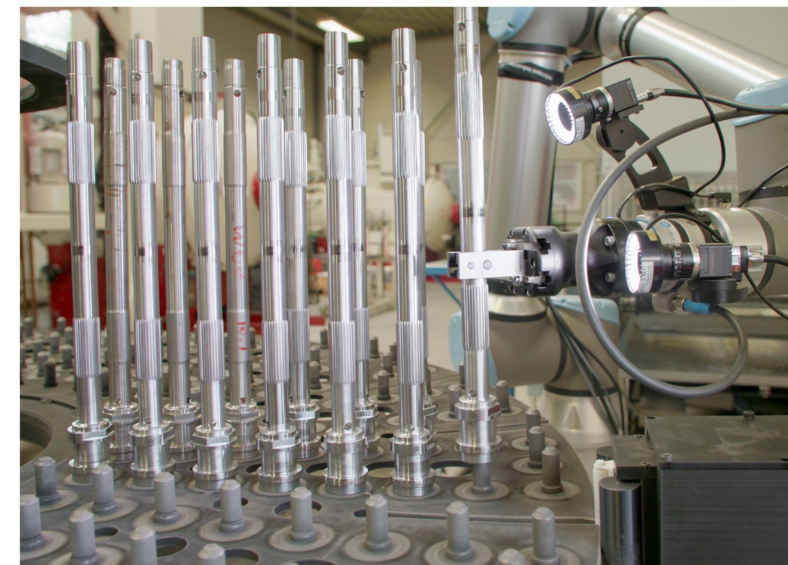
Ein mit dem MIRAI-System ausgestatteter Roboter führt eine Pick-and-Place-Aufgabe aus.
