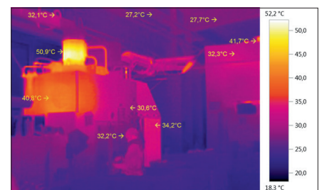
Aufnahme einer Wärmebildkamera für die Hallenklima-Simulation
