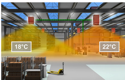
Durch dezentrale Geräte lassen sich Zonen mit verschiedenen Temperaturen realisieren.
