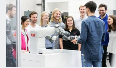
Kollaborative Roboter, kurz Cobots, sind für die direkte Interaktion mit dem Menschen konzipiert. Teilen sich Mensch und Roboter einen Arbeitsraum ohne trennende Schutzeinrichtung, wird das auch als Mensch-Roboter-Kollaboration (MRK) bezeichnet.
