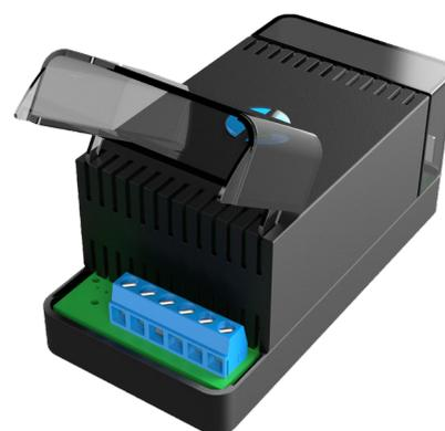
*Das intelligente Modul ROBA<sup>®</sup>-brake-checker überwacht ohne Sensoren neben dem Schaltzustand auch die Zugwegreserve und detektiert sicherheitskritische Veränderungen von Spannung, Luftspalt und Temperatur.*
