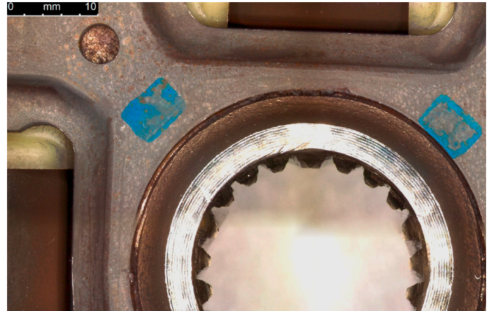
Übersichtsbild: Keilnabe einer Kupplungsscheibe
