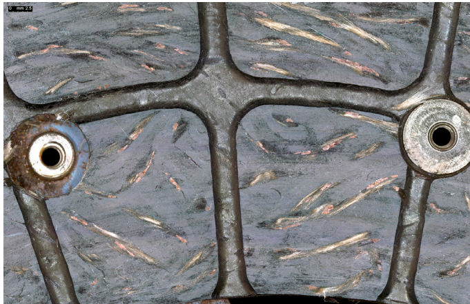
Übersichtsbild: Reibungsfläche einer Kupplungsscheibe
