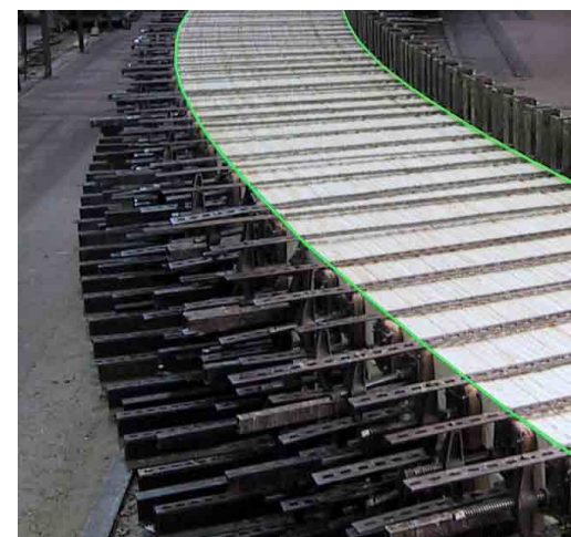
Projektion der Form, eines Leimbinders Projection of the form, a glue binder Projection de la forme sur le banc de collage
