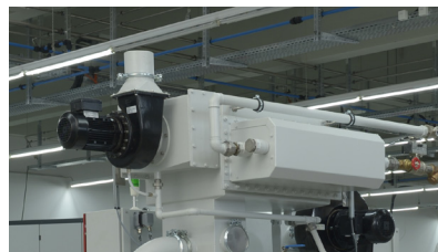
Wassergekühlter Schwadenkondensator (Option) – Absaugung und Kondensierung der Dampfschwaden
