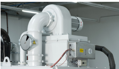
Lufterhitzer mit Blasdüsen – trocknet das Werkstück
