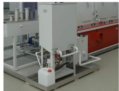
Ölabscheider UNI – separiert aufschwimmende Öle und Fette
