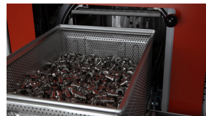
Reinigen in der Lochblech-Kiste
