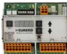
Peltier-Controller mit verschiedenen Regelungsprogrammen, umfangreichen Überwachungsfunktionen und Schnittstelle
