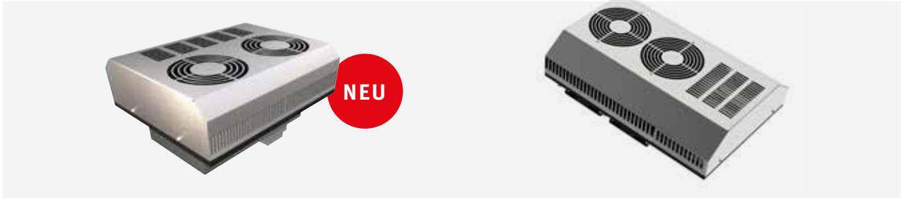
Die Peltier-Kühlgeräte PK 150-PS und PK 300-PS haben einen Weitbereichs-Spannungseingang für 100 – 240 V. Bei diesen Geräten ist die Spannungsversorgung integriert. Das geschützte Netzteil befindet sich auf der Außenseite des Kühlgerätes und damit außerhalb des zu kühlenden Schaltschranks. Es entfällt innen eine Wärmequelle. Dadurch ergeben sich eine einfache und schnellere Montage sowie weniger Platzbedarf im Gehäuse.
