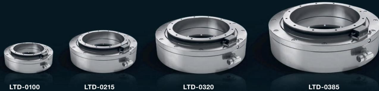
Franke **Drehtische vom Typ LTD** mit integriertem Direktantrieb zeichnen sich durch höchste Energieeffizienz aus. Die Integration des Antriebsmotors direkt ins Lager ermöglicht es, auf Bauteile wie Getriebe und Antriebsritzel und somit auf komplexe Schmierkreisläufe zu verzichten. Die bewegten Massen fallen deutlich geringer aus, Leistungsverlust durch Reibung wird minimiert.
