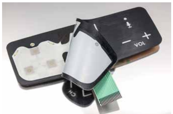
Beleuchtete Tasten mit der LGF Technologie
