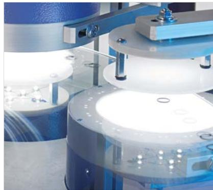
*Visuelle Prüfung von Abmessungen und Oberflächen*
