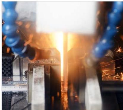
*Konfektionieren von Wellen und Schienen*
