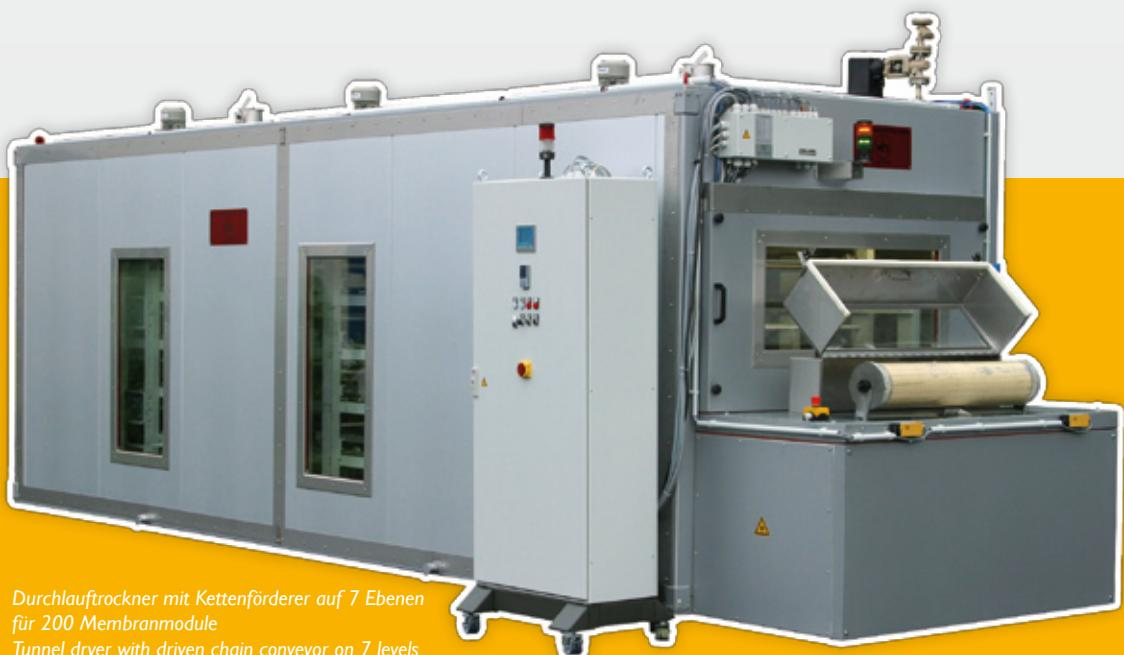
Durchlauftrockner mit Kettenförderer auf 7 Ebenen
