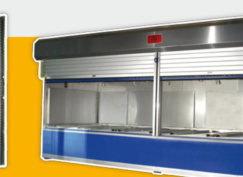
Aufschmelz Wärmekammer für 5x 1000l Fettblöcke mit beheizter Auffangwanne
