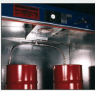
Fass Absauganschluss (mit Vakuum)
