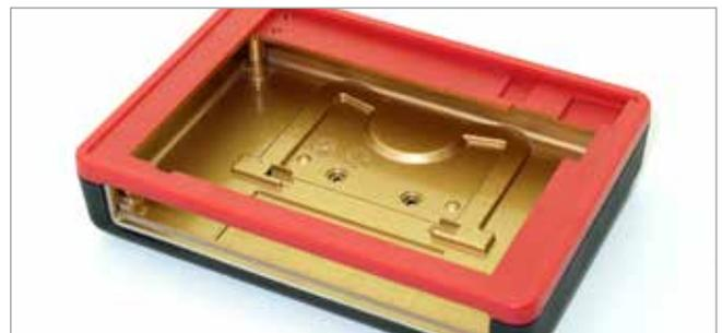
Gehäuse mit einer leitfähigen Kupferlackierung
