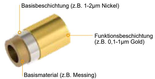
Die Stifthülse und der Kolben werden üblicherweise doppelt beschichtet (zunächst mit Nickel 1-2µm und anschließend mit Gold 0,1-1µm). Applikationsspezifisch sind auch andere Edelmetallbeschichtungen des Kolbens möglich:
