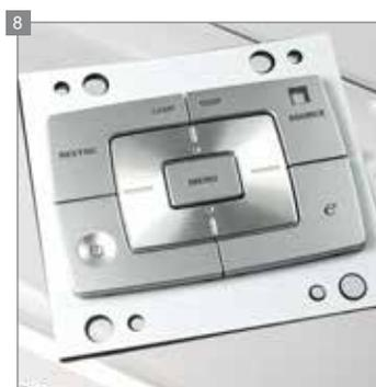
1. Silikonschaltmatte mit bedruckten Silikontasten und Lichtleiterelementen aus Silikon, sowie opakem light-separation Element zur Lichttrennung.
