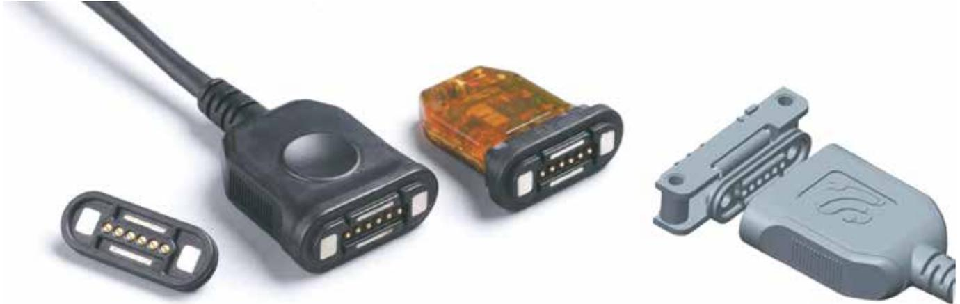
Bei magnetischen Steckverbindern besteht der Stecker aus Federkontaktstiften und einem magnetischen Verbindungssystem. Die Implementierung eines Magneten sorgt für eine schnelle schock- und vibrationsbeständige, sowie selbstführende Verbindung bzw. einfache Lösung von Stecker und Gerät.
